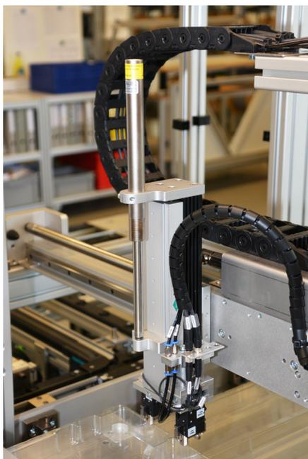
Die Magnetische Feder MagSpring (Bildmitte, Zylinder mit gelbem Aufkleber) kompensiert das Eigengewicht der Linearachse und hält sie auch bei Stromunterbrechung in sicherer Position. (Foto: Rossmann)
