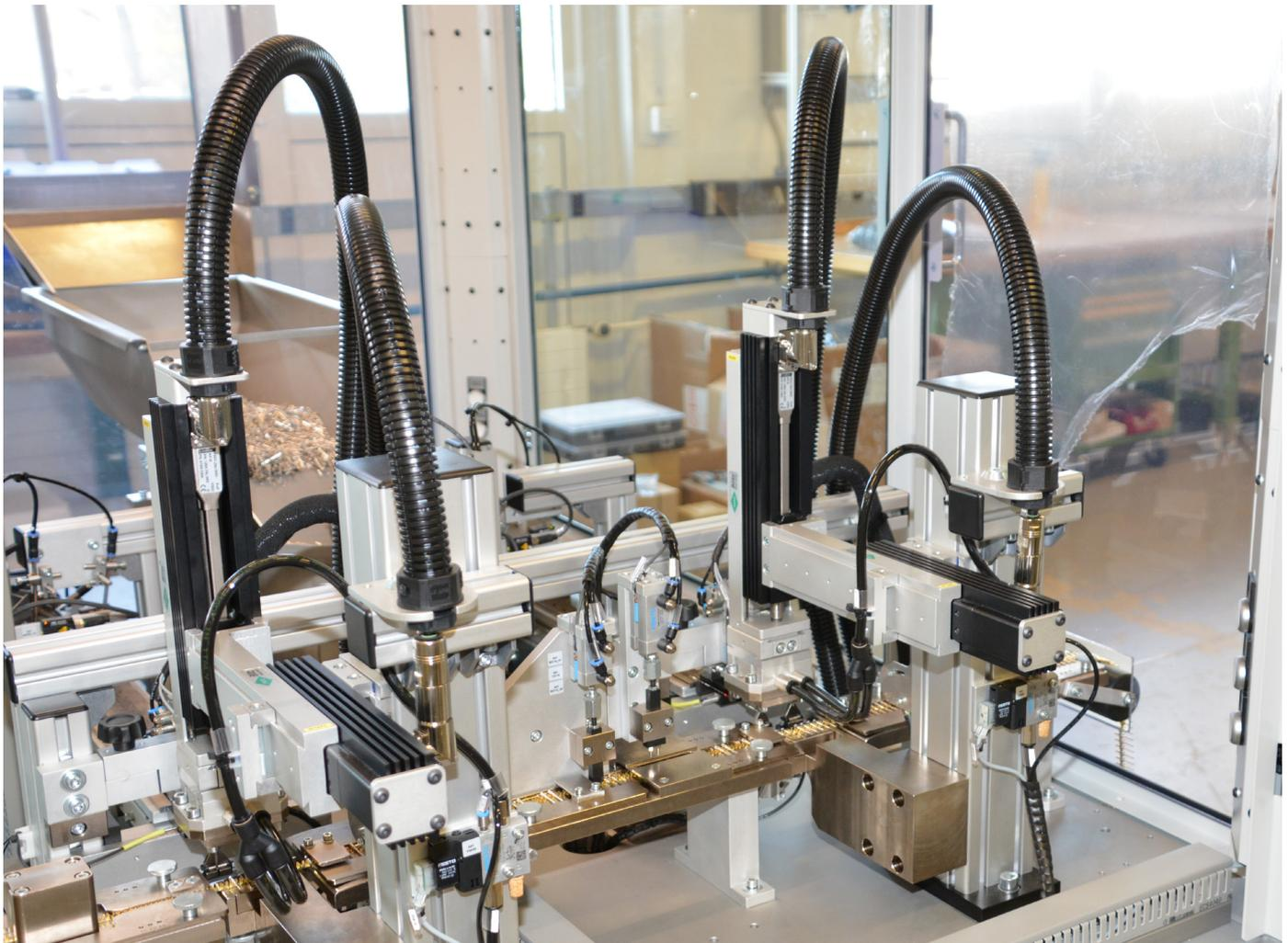
*Neben klassischen Pick&Place-Operationen kann der PARO-Blitz dank der integrierten Messsystems der Linearmotoren und der damit regelbaren Kraftaufbringung auch für Press- oder Biegeprozesse eingesetzt werden. (Foto: Rossmann)*
