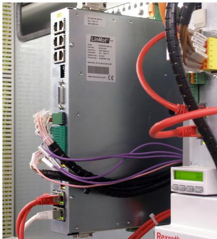
*Der Regler E1400 mit direkter Netzeinspeisung versorgt den Linearmotor P10-70 mit ausreichend Energie. Für die Anbindung an die Bewegungssteuerung stehen diverse Schnittstellen wie Sercos III (im Bild), ProfiNET oder POWERLINK zur Verfügung. (Foto: Roßmann)*
