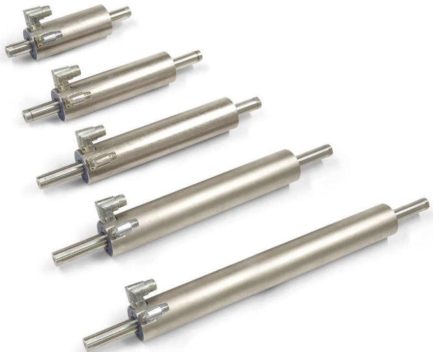
*Die Linearmotoren aus der Serie P10-70 sind mit Spitzenkräften bis zu 2.500 N die leistungsstärksten Motoren aus dem LinMot-Programm. Dank ihrer modularen Bauweise lassen sich Hübe zwischen 10 und 1.770 mm implementieren. (Foto: LinMot)*
