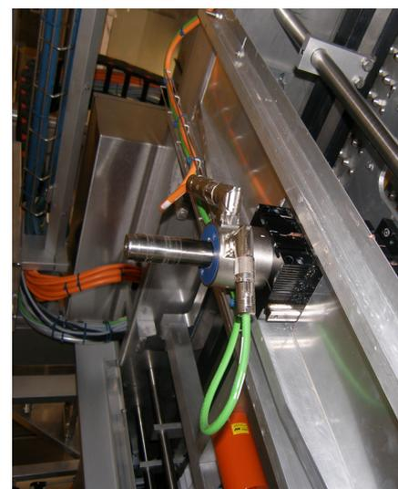
Ein tubularer Linearmotor von LinMot mit Dreiphasenwicklung sorgt in der neuen Gießmaschine für ein präzises, dynamisches, geregeltes und gleichzeitig sanftes Anheben der Formen. (Foto: Roßmann)
