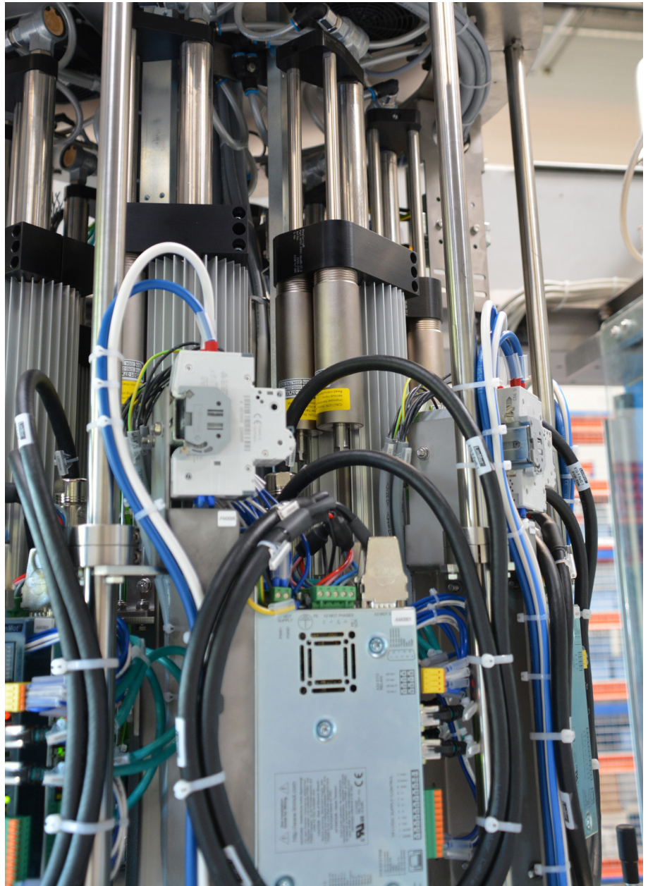
Magnetische Federn (im Bild links von den Kühlrippen) kompensieren das Eigengewicht der Verschleißspindeln und halten sie auch bei Stromunterbrechung in sicherer Position.
