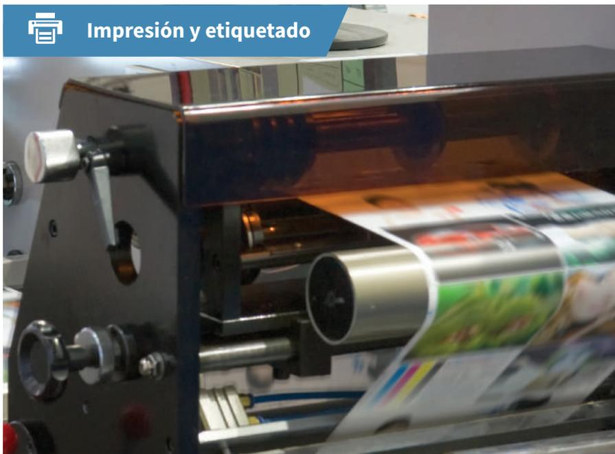
Los productos sensibles pueden ser impresos más rápidamente utilizando la tecnología de motor lineal, debido a que el proceso de impresión se realiza gestionando posición, velocidad y control de la fuerza. No se producen impactos de fuerza que, por ejemplo, están asociados a las soluciones neumáticas.
