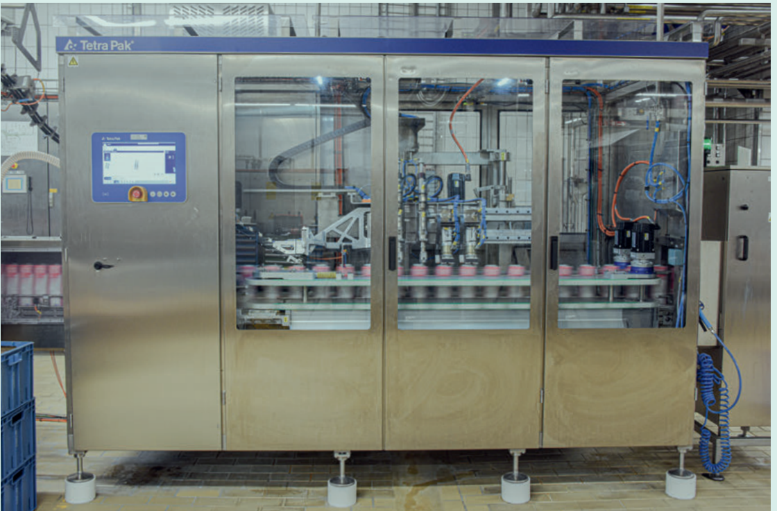
Der gesamte Prozess auf einen Blick. Vom Setzen der Verschlüsse über das Positionieren bis zum Verschließen.
