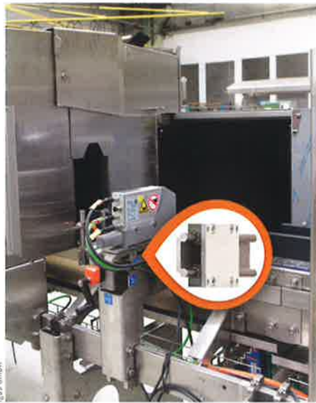
Ausleitsystem zum Aussortieren von Flaschen mit Formatverstellung des Linearmotors mittels drylin WS-1040 aus Edelstahl.
