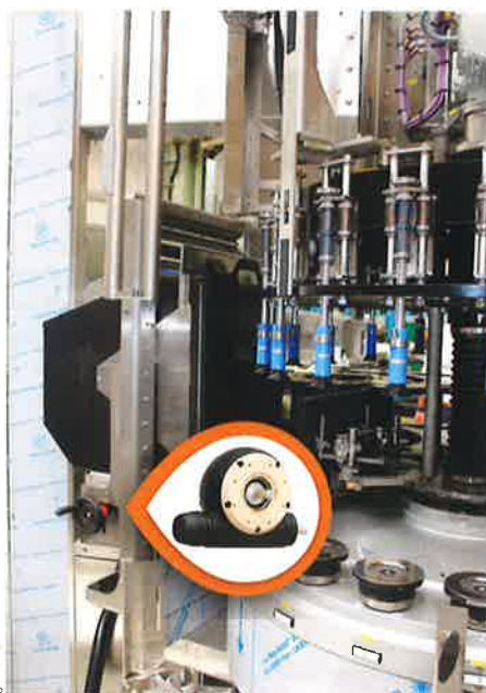
Behälterausrichtung im Etikettierer zur Justage der Pressnaht vor dem Etikettieren mit robolink Apiro-Gelenk und dryspin Trapezgewindemutter.
