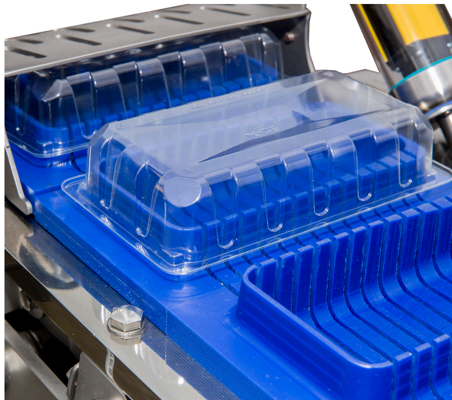
Produktträger mit einer Aussparung in Form des Schnittguts sorgen für den Erhalt der ursprünglichen Form des Schnittguts. (Foto: Thielemann)
