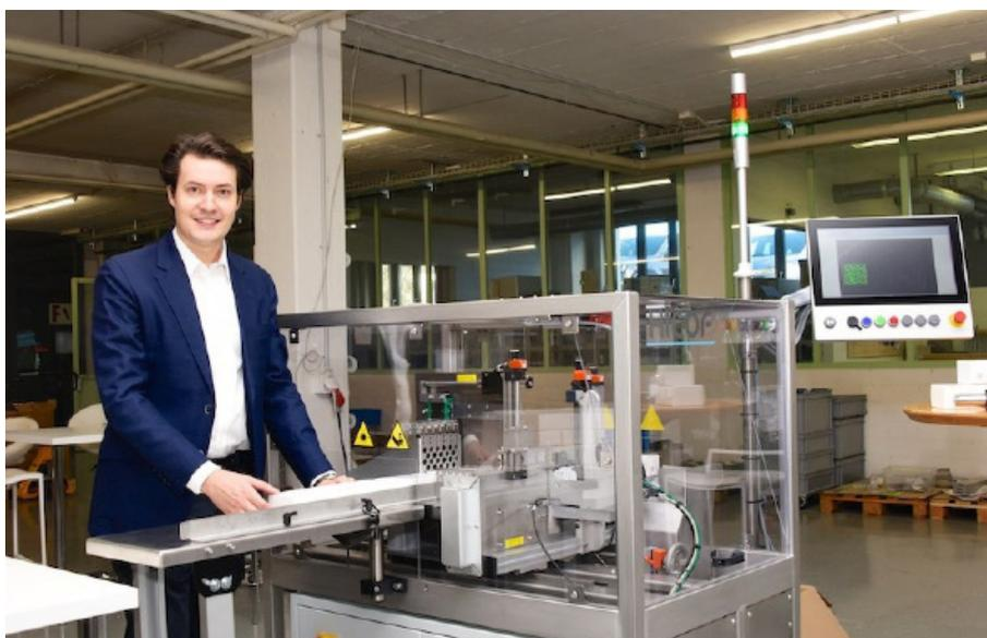
*Ein Flaggschiff der Hicof-Maschinen, der AMACODER, richtet die Packungen millimetergenau aus. Ohne die Wiederholgenauigkeit der LinMot Antriebe wäre eine solche Präzision nicht möglich.*
