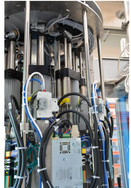
Magnetische Federn (im Bild rechts vom schwarzen Kühlkörper) kompensieren das Eigengewicht der Verschleißspindeln und halten sie auch bei Stromunterbrechung in sicherer Position.
