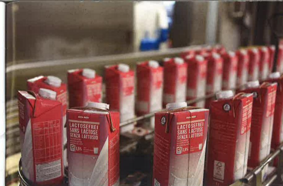
können, brauchte Emmi eine Lösung, die wieder verschließbar ist und sich einfach sowie ohne Krafteinsatz öffnen lässt. Auch wichtig: Das Getränk muss einschenkbar sein, ohne dass etwas verschüttet wird. Die Antwort auf diese Anforderungen: ein Wing-Cap-Verschluss.
