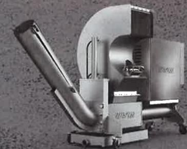
Mit den PUEHLER Pressen von WEIMA entwässern und verpressen Sie gefüllte Milchkartons, Dosen, PET-Flaschen und mehr in nur einem Arbeitsschritt.
