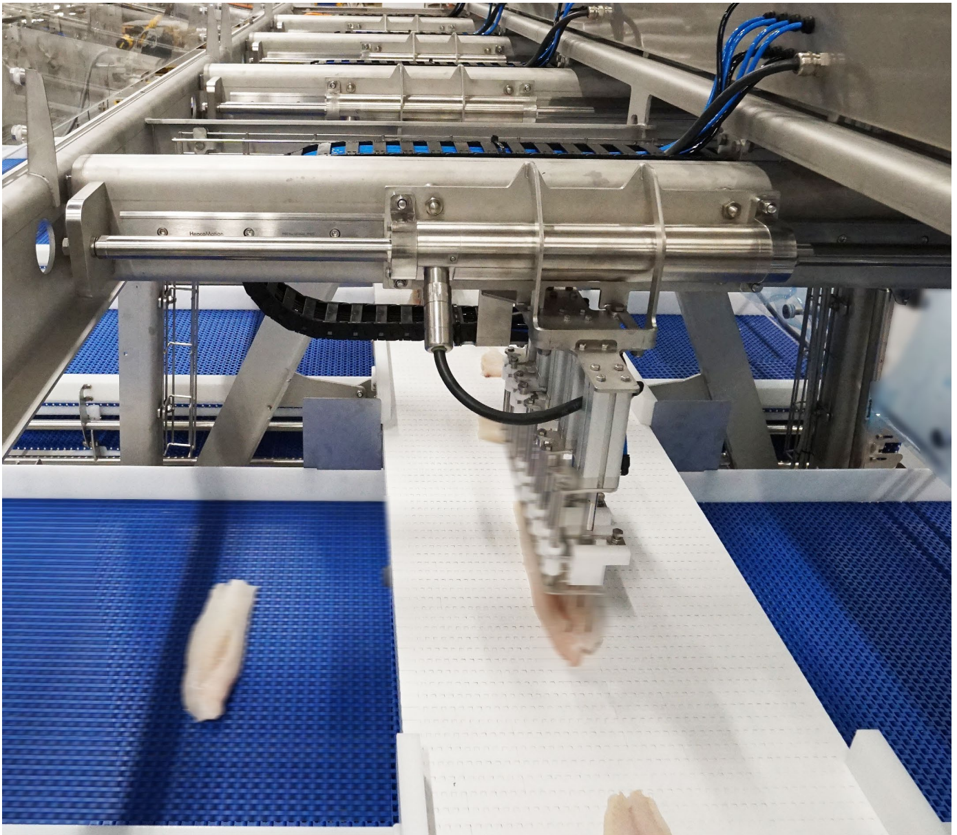
Realisierung des Portionsortierers mit einem LinMot Edelstahl Motor (Photo: Valka)
