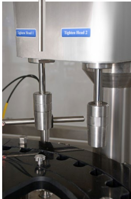
Schraubköpfe mit integrierten PR02 LinMot Hubdrehmotoren (Foto: AFAQ)
