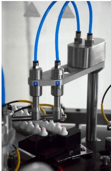
Pick-and-Place-Roboterarms für das Platzieren von Einsätzen und Kappen (Foto: AFAQ)
