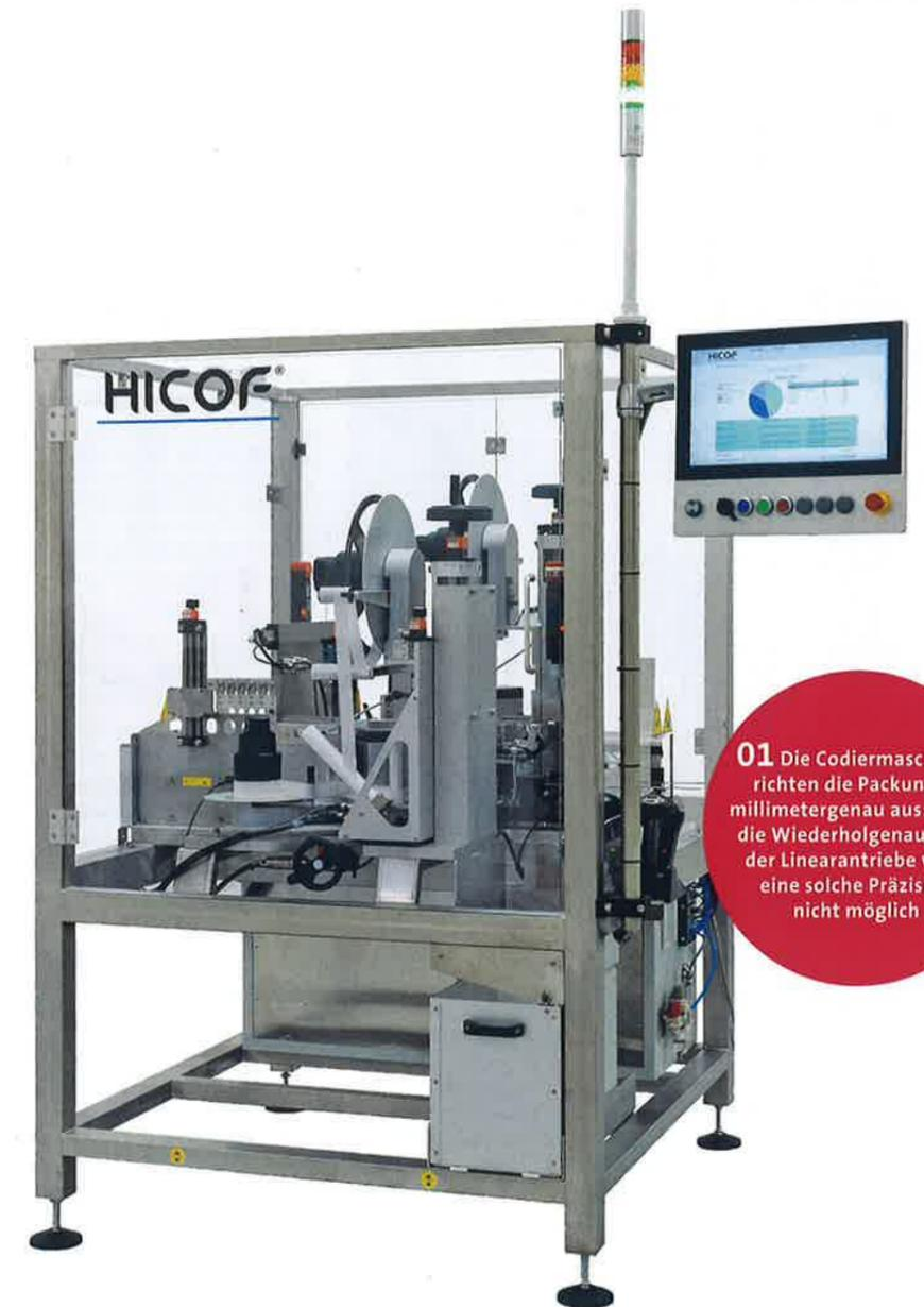
**01** Die Codiermaschinen richten die Packungen millimetergenau aus: Ohne die Wiederholgenauigkeit der Linearantriebe wäre eine solche Präzision nicht möglich
