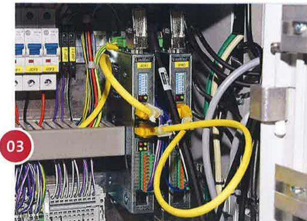
**02** Da Linmot-Antriebe eine invariante Reproduktion der Prozessvariablen gewährleisten, kann die Druck- und Leseinheit der Codiermaschine einwandfrei ausgerichtete Produkte nahezu ausschussfrei bedrucken und etikettieren
