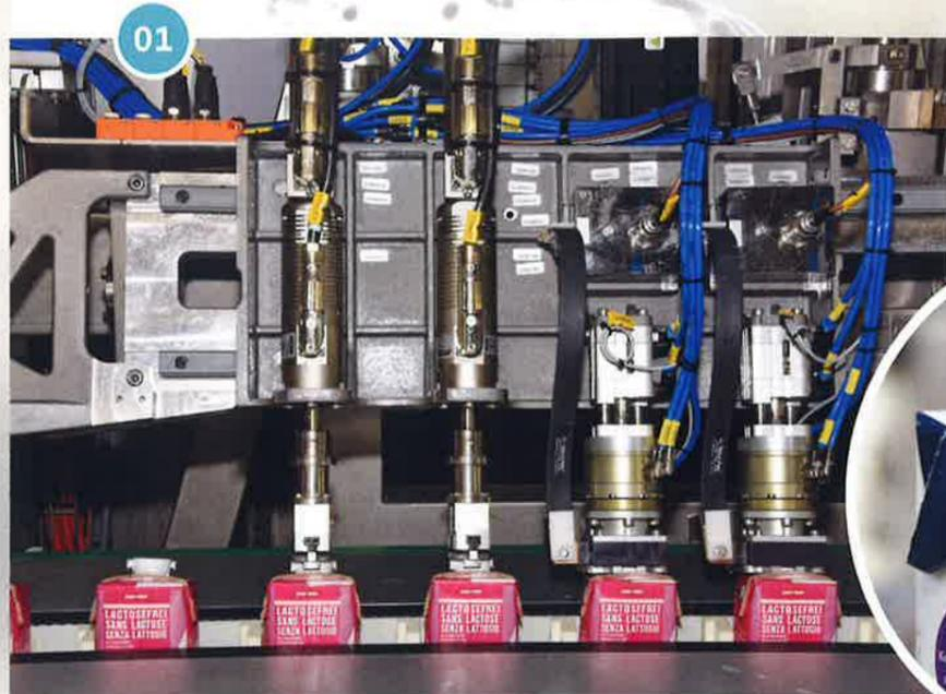
**01** Der gesamte Prozess auf einen Blick: vom Platzieren der Verschlüsse über das Positionieren bis zur Versiegelung
